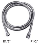
Flexo doble engatillado de 1,70 m. tuerca cónica con junta tórica y arandela prisionera en racord. Garantía diez años
